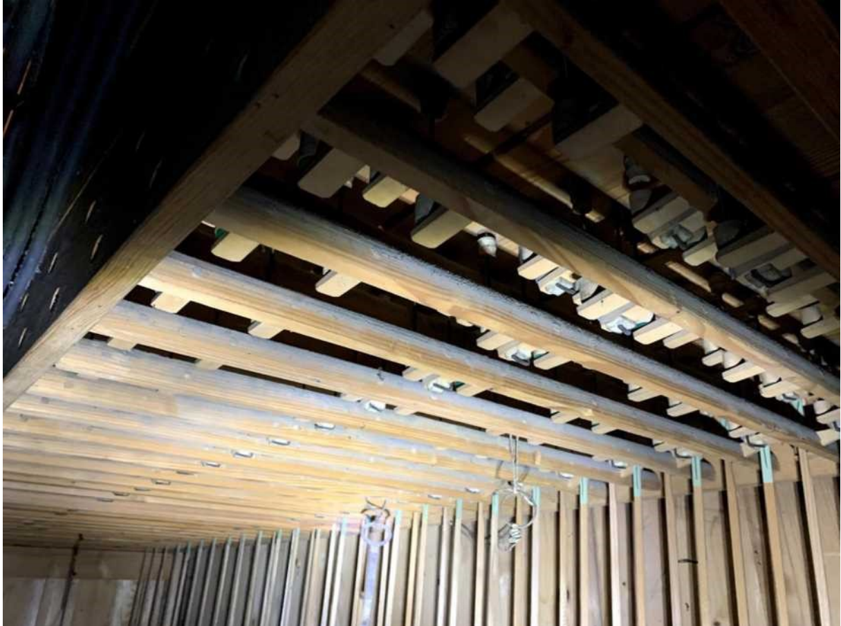
Traktura mechaniczna wiatrownic stożkowych.
