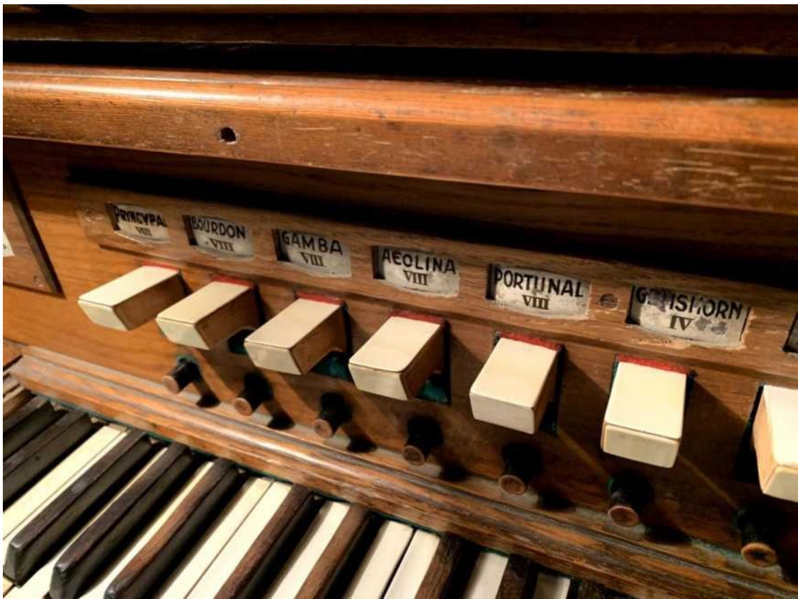
Zużyte włączniki oraz tabliczki rejestrowe
