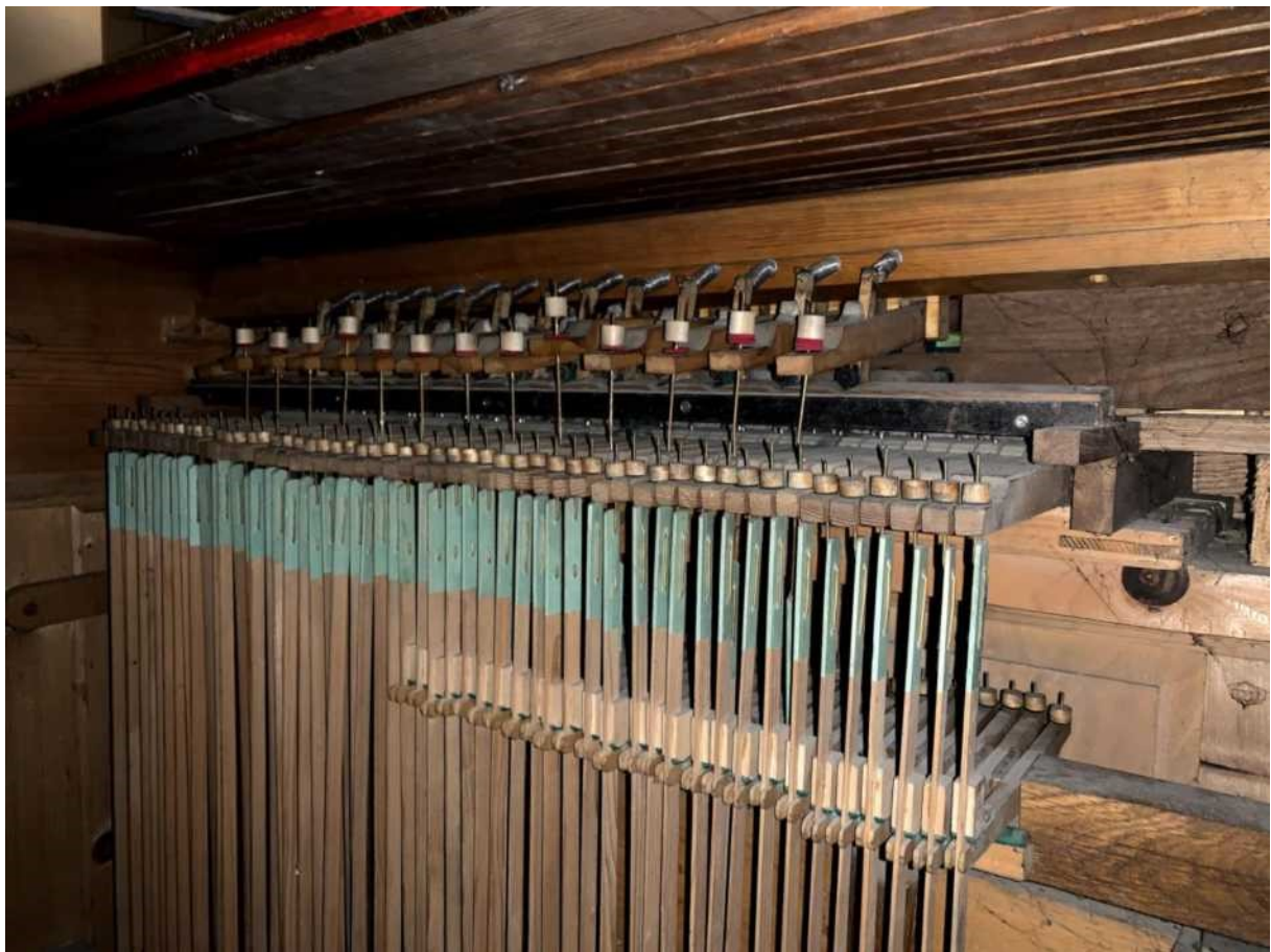
zużyte elementy traktury organów kwalifikujące się do wymiany
